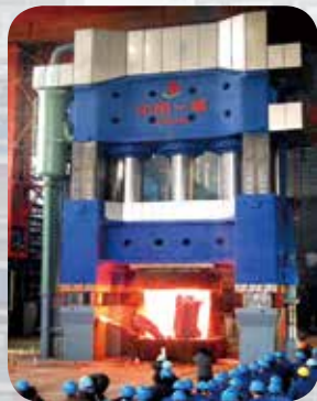
1500吨自由锻造水压机的国家科技进步一等奖应用于中国第一重型机械集团
